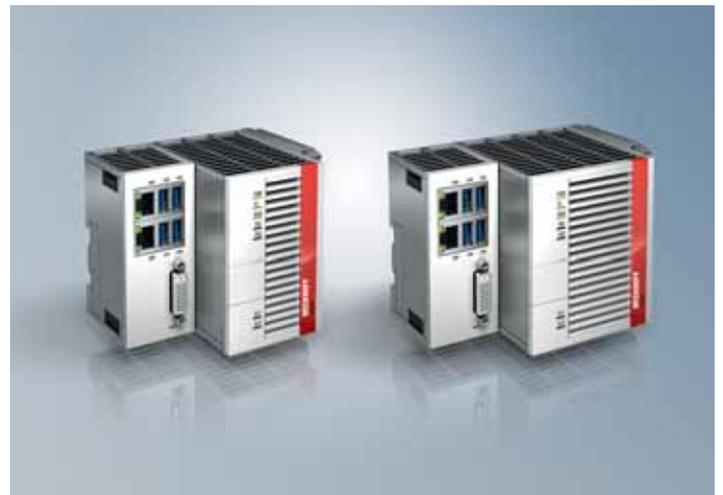
Außerdem zeigt Beckhoff weitere aktuelle Highlights für die Medien- und Entertainmenttechnik: zum einen die hutschienenmontierbaren Embedded-PCs der Serie CX5600 mit AMD-Ryzen-Prozessoren.
